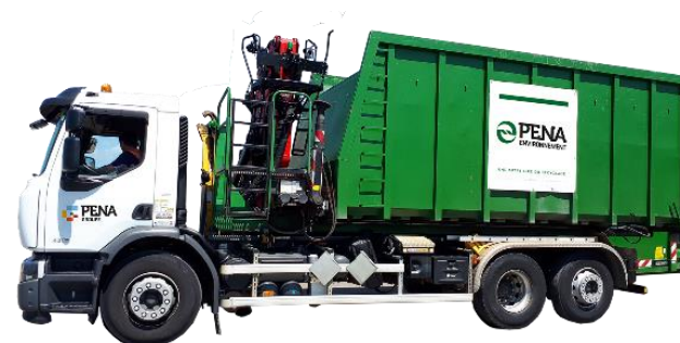
Camion ampliroll équipé d'un grappin
